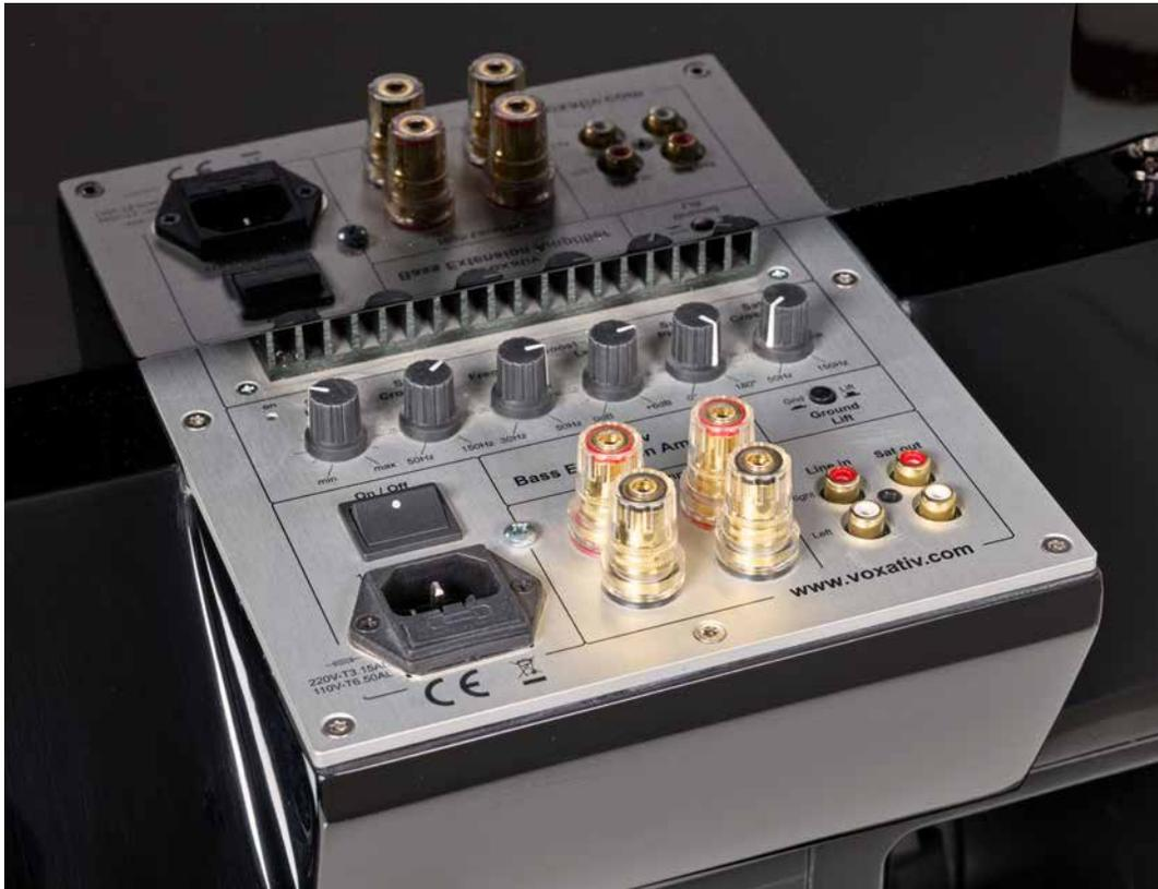
Der Sub erwies sich im Test als extrem vielseitig: Er kann sowohl über Line- wie auch mit Hochpegelsignalen angesteuert werden. Neben der stufenlos regelbaren oberen Grenzfrequenz bietet er ein Hochpassfilter für durchgeschleifte Lautsprecher. Außerdem gibt es einen Peak-Equalizer, der eine leichte Betonung im Frequenzbereich zwischen 30 und 50 Hz setzen kann. Das kann helfen, den Übergang zwischen Woofer und Satelliten nahtlos zu gestalten.
