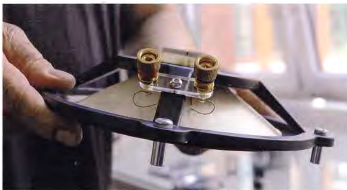
◀ Ein stabiler Korb bietet der leichten, aus Holz hergestellten Membran den perfekten Arbeitsrahmen.
